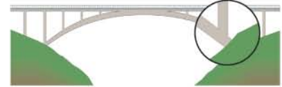
arc M encastré fixed arch arco M fijo gelenkloser Bogen M arco M senza cerniere F
